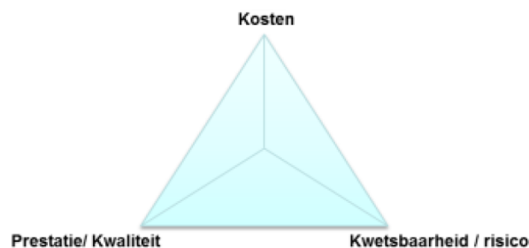
Figuur 1.1 Asset management driehoek: prestatie (betrouwbaarheid, beschikbaarheid, onderhoudbaarheid), risico's (veiligheid, gezondheid, economie, milieu, politiek) en kosten (beheer en onderhoud, verbetermaatregel, inrichtingsmaatregel) in balans: Bij asset management staan de prestaties, kwetsbaarheid en risico's, kosten en baten van assets centraal. Door in deze drie aspecten inzicht te geven, kunnen de assets effectiever en efficiënter beheerd worden.
